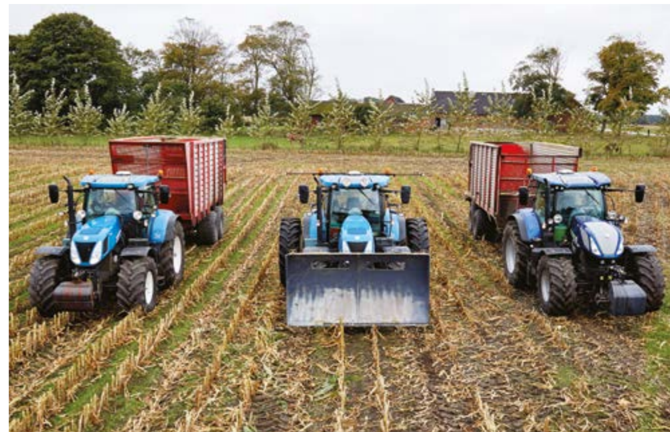
Alle nye traktorer udstyres med New Holland PLM Connect RTK og autostyring. GPS-antenne er monteret på førerhusenes tag.
